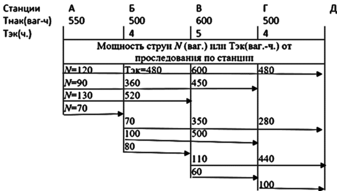
Рисунок 8.6 – Пример ступенчатого графика вагонопотоков для расчета оптимального плана формирования
